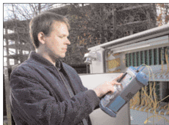
Realización del cálculo de promedio completo en 45 segundos utilizando las configuraciones de OTDR de rango corto.
